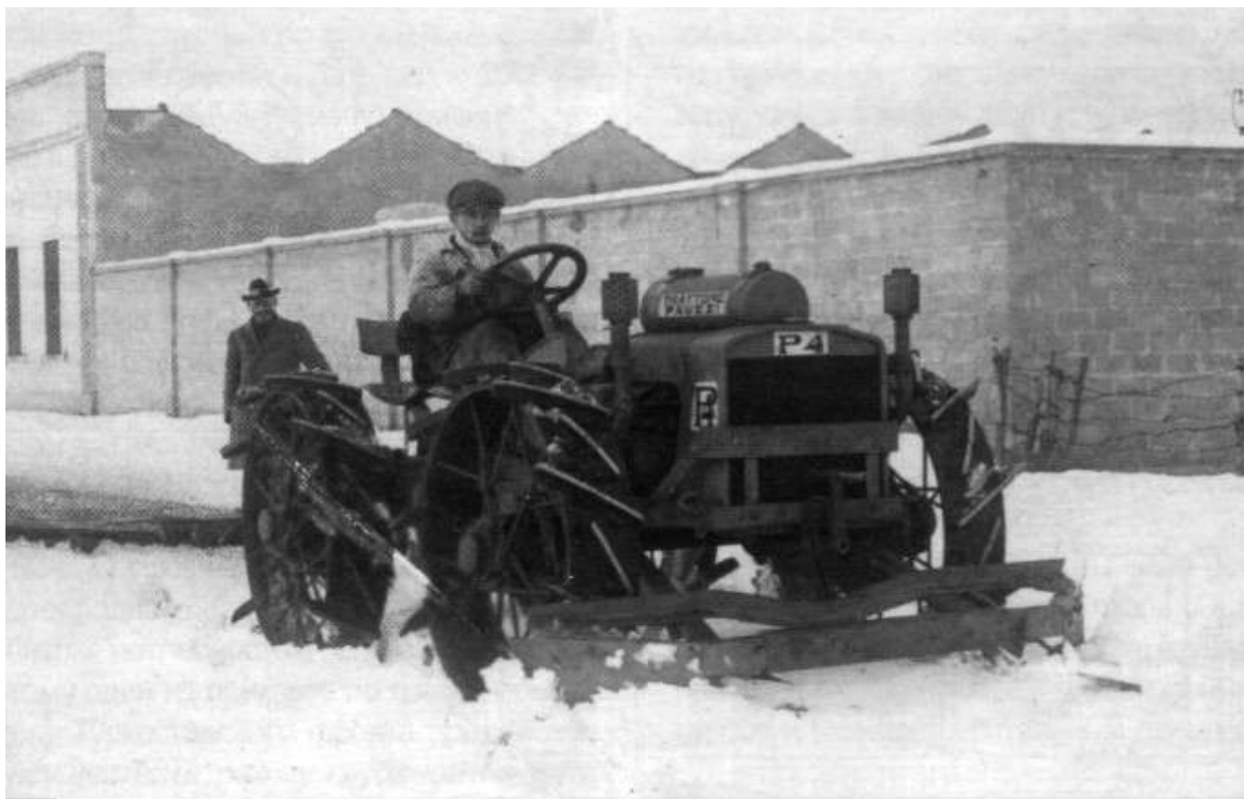
Трактор «Павези» с плугом-снегоочистителем, предлагавшийся к поставкам в 1923 г.
